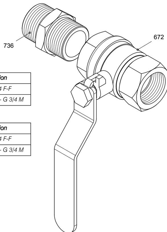
**Istruzione di montaggio / Assembling Instruction**Collocare sulle filettature un liquido sigillante di tenuta tipo Superbond 320.
